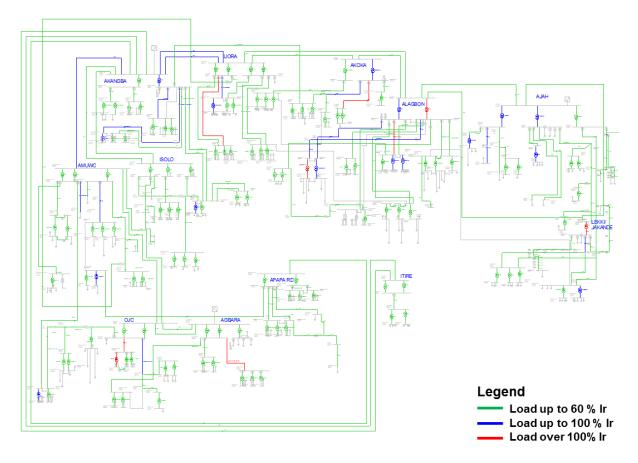
FIGURE 12: EKO DISCO NETWORK MODEL ON SINCAL
